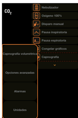
Imagen 7-9. Menú configuración de alarmas capnografía
