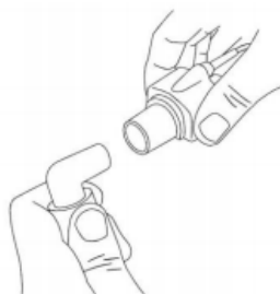
Imagen 7-7. Conexión del adaptador con el accesorio usado como interfaz
