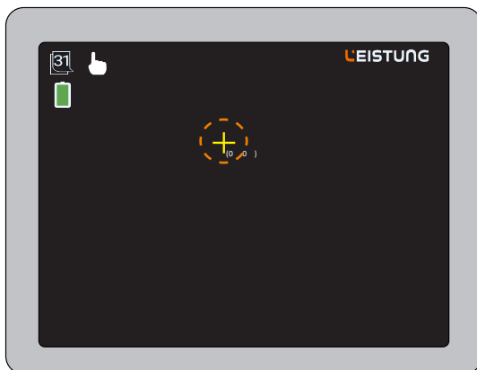
Imagen 5-22. Calibración de la pantalla táctil - Paso 1
