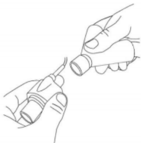
Imagen 7-4. Conexión del adaptador con la pieza en Y
