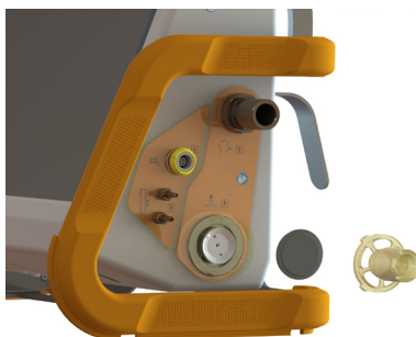
Imagen 4-10. Conexión de la válvula espiratoria
