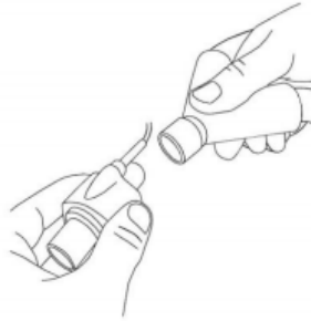
Imagen 7-6. Conexión del adaptador con la pieza en Y
