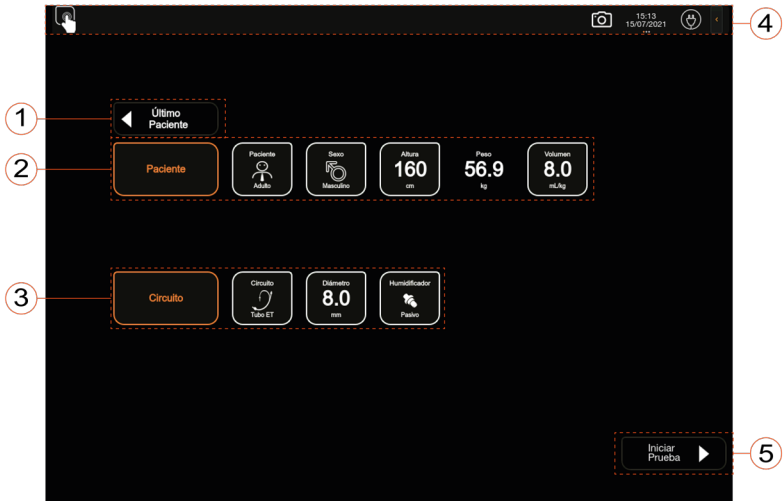
Imagen 5-2. Sectores de la pantalla de inicio. 1) Botón Último Paciente. 2) Paciente. 3) Circuito. 4) Panel de íconos. 5) Botón Iniciar Prueba.
